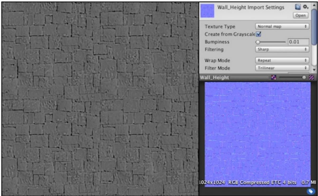
图7.17 当勾选了Create from Grayscale后，Unity会根据高度图来生成一张切线空间下的法线纹理
