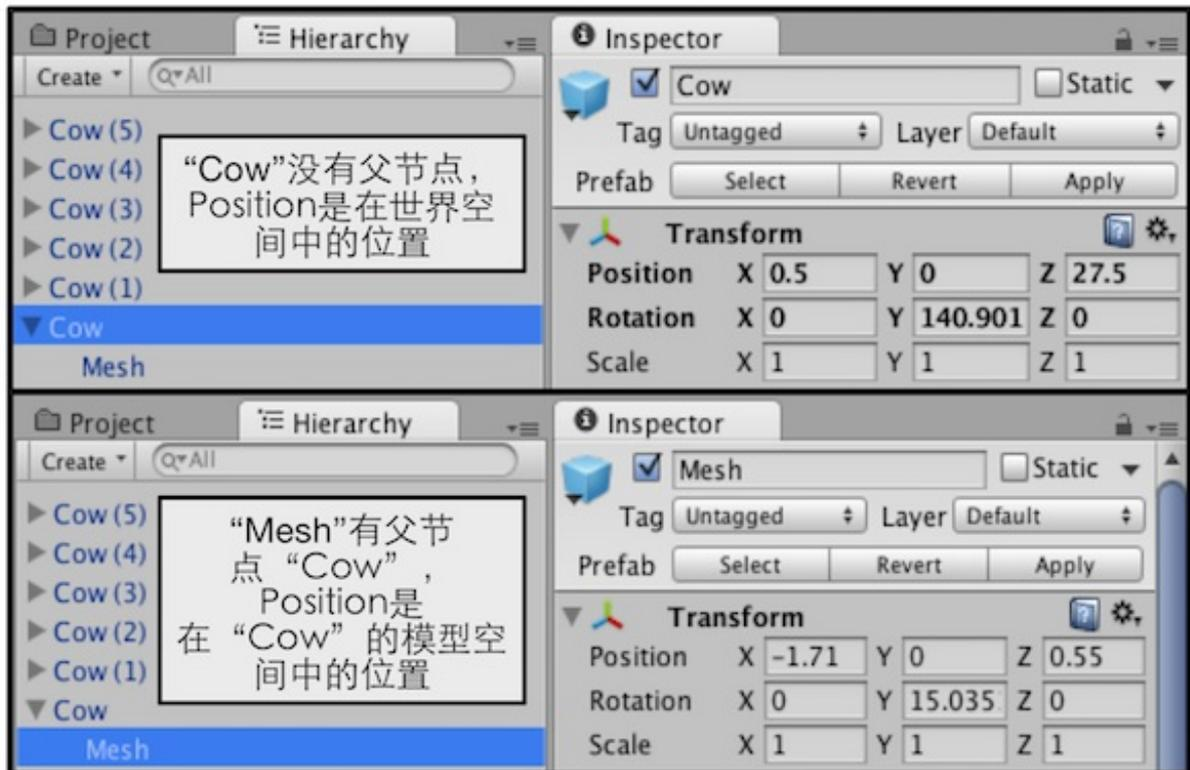
图4.33 Unity的Transform组件可以调节模型的位置.如果Transform有父节点, 如图中的“Mesh”, 那么Position将是在其父节点 (这里是“Cow”) 的模型空间中的位置; 如果没有父节点, Position就是在世界空间中的位置
