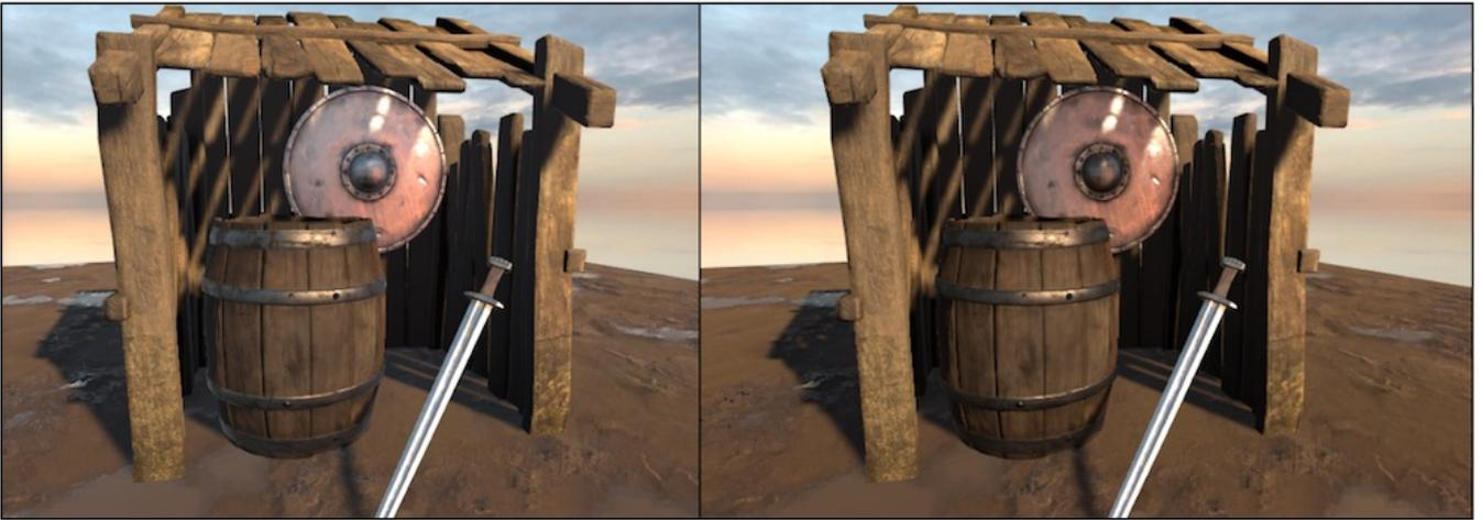
图18.15 左图：未使用反射探针。右图：在场景中放置了两个反射探针，注意墙上的盾牌与左图的差别
